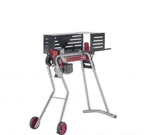
Liegender Holzspalter mit bis zu 52 cm Spaltlänge und 5,0 t Spaltkraft
